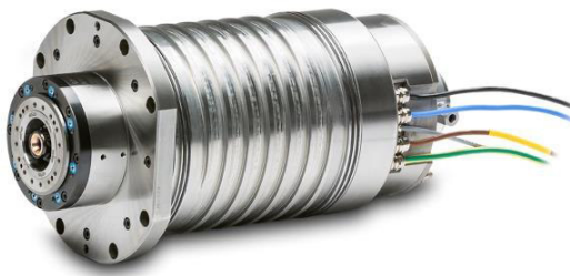
Einschubspindel HSG-E 198.18.AK HSK-A63, 18.000U/min. 38kW
