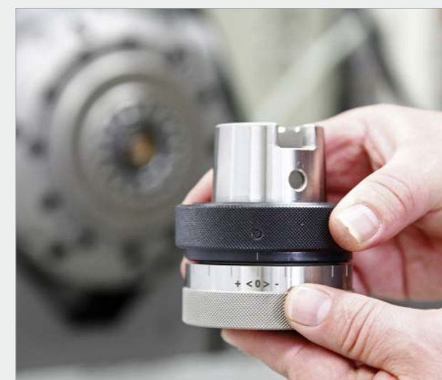
Einstelllehre Spannsystem / drawbar adjustment gauge
