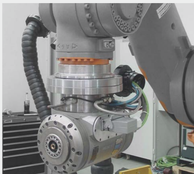
7-Achs Roboter mit Diebold Hochleistungsspindel / 7-axis robot with Diebold high-performance spindle
