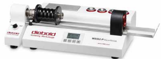
Schrumpfgerät mit allem Zubehör Shrink unit with all accessories
