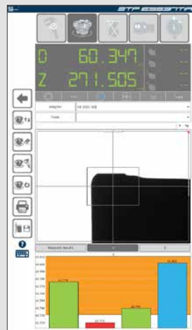
Rundlauf-Funktion runout function
