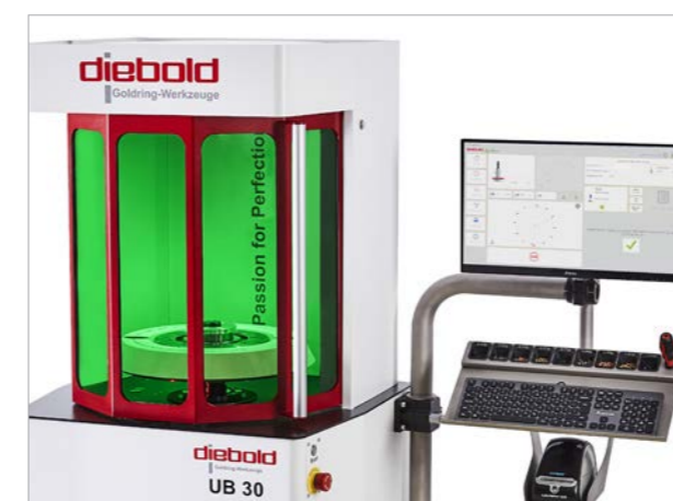
Visualisierung Wuchtergebnis in der Toleranz / Visualization balancing result in tolerance
